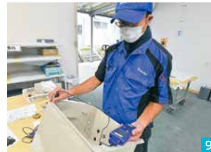
6 7 塗装には「粉体塗装」と「溶剤塗装」の2つがある。粉体塗装は静電気による塗装を施した板金を180℃の高温で乾燥させる。今年度中には3Dスキャンにより製品の形状に合わせて自在に粉体塗装ができるラインを導入予定。8 専門分野の知識を持った社員が製品仕様に基づき、メカ・電装品の組立作業を行う。9 塗装検査では計測器により膜厚や光沢を検査するほか、目視で製品の肌やゴミ、塗装のタレなどがないかも確認。
