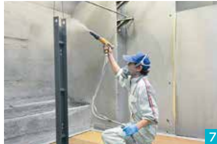
6 7 塗装には「粉体塗装」と「溶剤塗装」の2つがある。粉体塗装は静電気による塗装を施した板金を180℃の高温で乾燥させる。今年度中には3Dスキャンにより製品の形状に合わせて自在に粉体塗装ができるラインを導入予定。8 専門分野の知識を持った社員が製品仕様に基づき、メカ・電装品の組立作業を行う。9 塗装検査では計測器により膜厚や光沢を検査するほか、目視で製品の肌やゴミ、塗装のタレなどがないかも確認。
